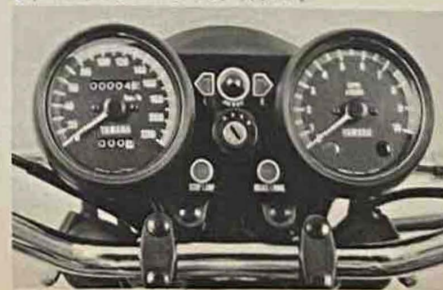
●中央に見やすい配置された各種パイロットランプ。
