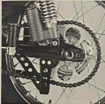
●サーマルフロー付5段切換式リヤクッション。
