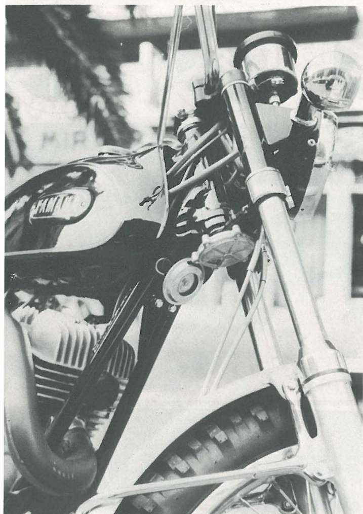
Le braquage assez important est de 98° de gauche à droite.
