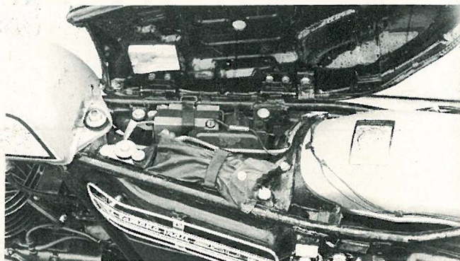
Sous la selle prennent place, l'appareillage électrique, la batterie, le réservoir d'huile et la trousse à outils.
