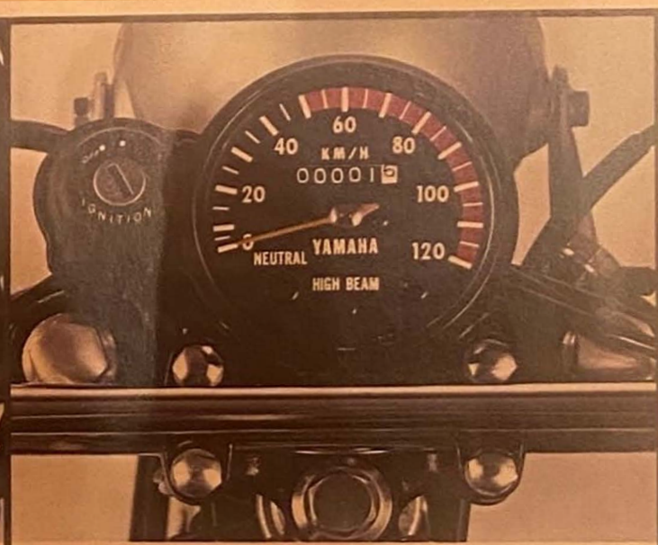
●オフ・ロードでも、夜間でも、読みやすいメーター・レイアウト。オフ・ロードでも安定したライディング・フォームを提供できるブリッジ付きのアップハンドル。DT125には、タコメーターも装備。
