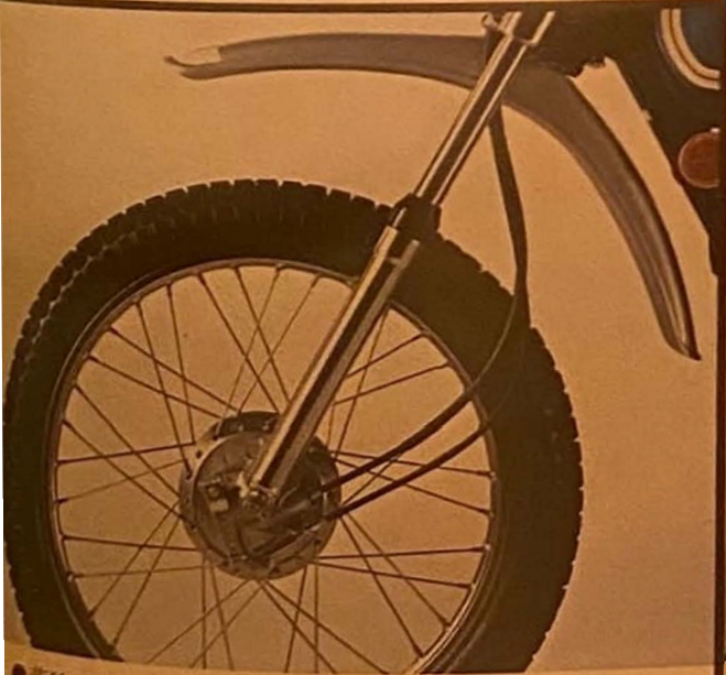
●苛酷な走行条件を考え、ポリプロピレン製のフェンダーを採用。タイヤとのクリアランスも考慮されています。
