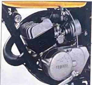
●その実力は実証済み、強力5ポート単気筒エンジン
