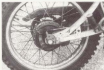
Bild 20 Bei Betätigung der Hinterradbremse soll der Winkel zwischen Bremsstange und Verbindungslinie der beiden Drehpunkte des Bremsküssels ein rechter sein
