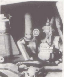
Bild 84 Das ist der Verbindungsschlauch vom Ansaugstutzen zum Druckspeicher des -YAMAHA ENERGY INDUCTION SYSTEM (YEIS)-
