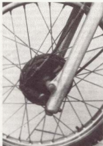
Bild 19 Bei Betätigung der Vorderradbremse bilden Bremsküssel und Bowdenzug einen rechten Winkel
