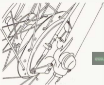
Bild 210 Die Nut in der Bremsankerplatte muss den Bremsanker am Gabelstiel umfassen!
