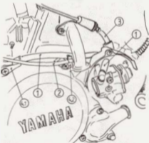
Bild 78 Zur Ölpumpe für die Frischöltschmierung:
