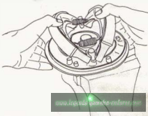
Bild 224 So «faltet» man die Bremsbacken auf oder runter und «überstülpt» so die recht kräftigen Rückstellfedern
