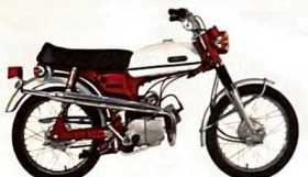
ヤマハトレール50F5-C ●最高出力5.4ps/8000r.p.m. ●最高速度85km/h ●最大トルク0.5kg-m/7500r.p.m. ●現金正価 ¥63,000
