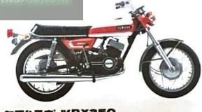
ヤマハスポーヰRX350 ●最高出力36ps/7000r.p.m. ●最高速度170km/h ●最大トルク3.87kg-m/6500r.p.m. ●現金正価 ¥216,000
