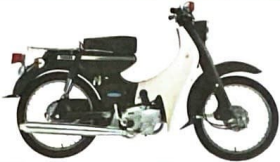
ヤマハメイトハイテラックス50 U5-AD U5-AE ●最高出力4.5ps/6500r.p.m. ●最高速度79km/h ●最大トルク0.52kg-m/5000r.p.m. ●現金正価 ¥60,000 ¥67,000(AE)
