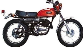
ヤマハトレールLDT250 ●最高出力21ps/6500r.p.m. ●最高速度120km/h ●最大トルク2.40kg-m/5500r.p.m. ●現金正価 ¥205,000
