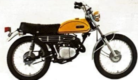
ヤマハトレール90HT1 ●最高出力8.5ps/7000r.p.m. ●最高速度95km/h ●最大トルク0.9kg-m/6500r.p.m. ●現金正価 ¥92,000
