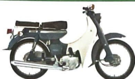
ヤマハメイトハイテラックス70 U7-A U7-AE ●最高出力6.2ps/7000r.p.m. ●最高速度85km/h ●最大トルク0.7kg-m/4500r.p.m. ●現金正価 ¥66,000 ¥73,000(AE)
