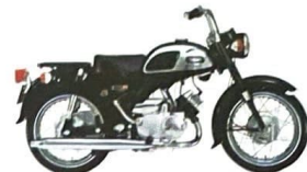
ヤマハ125A7 ●最高出力11ps/6700r.p.m. ●最高速度110km/h ●最大トルク1.25kg-m/5000r.p.m. ●現金正価 ¥135,000
