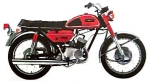
ヤマハスポーヰ160 CS2-E ●最高出力21ps/7500r.p.m. ●最高速度140km/h ●最大トルク2.05kg-m/7000r.p.m. ●現金正価 ¥169,000
