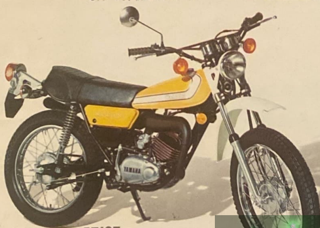
DT125 ● ¥183,000 ●2サイクル・空冷 ●13馬力 ●リターン式5段 ●コンペティションイエロー、チャビレッド
