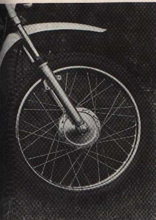
Les jantes en acier sont équipées de pneus trial. Les freins sont puissants. Le garde-boue en plastique type cross est relevé.
