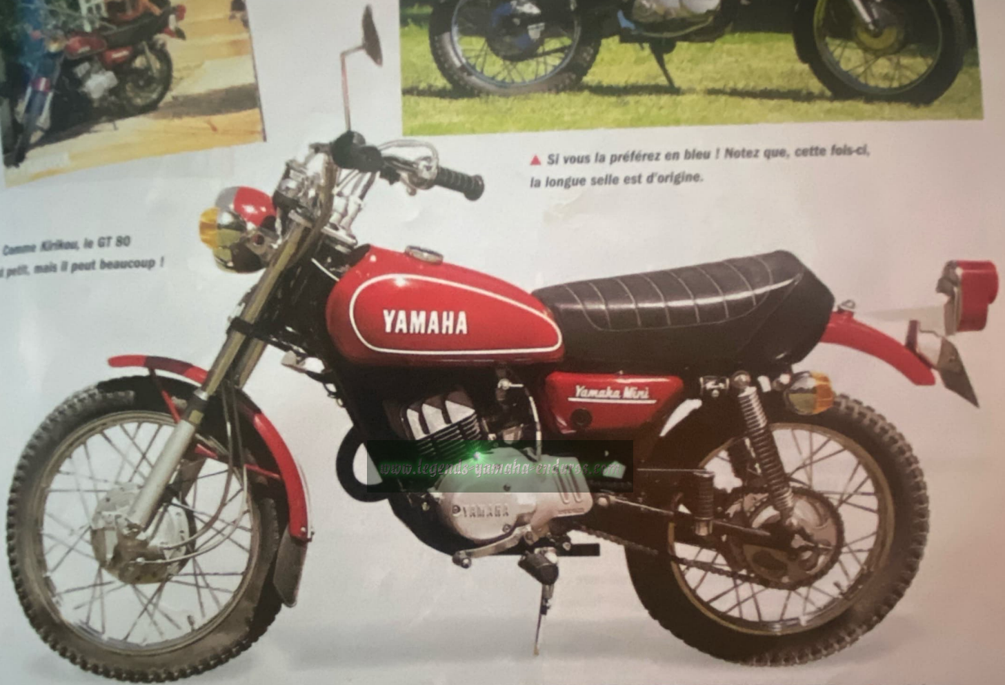
◀ Le généreux tambour avant simple-came remplit parfaitement son rôle.
