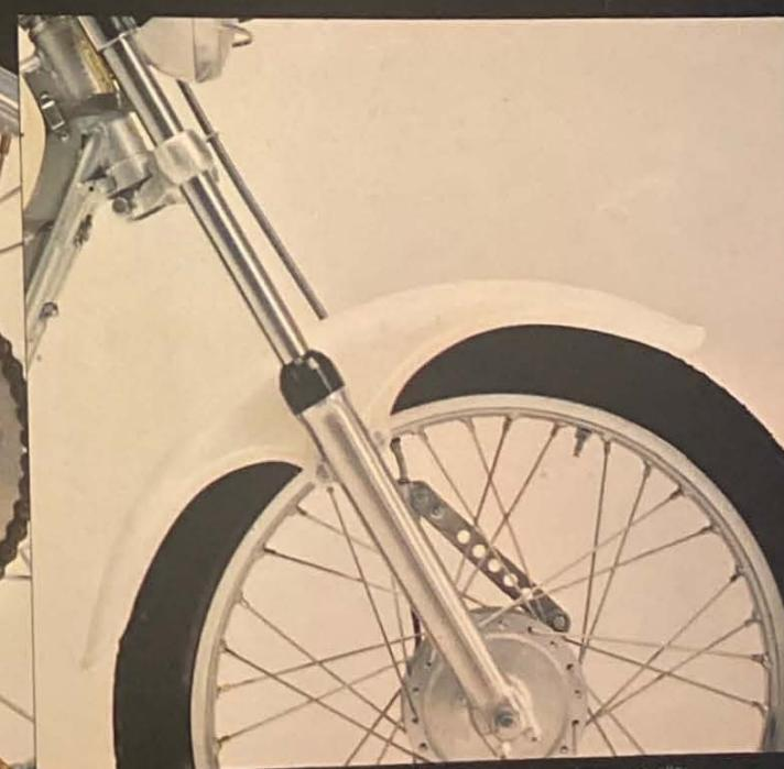
**Trials front forks** have extremely soft damping action. Hubs and rims are alloy. Fenders are polypropylene. **Les fourches d'essais avant** procurent un jeu d'amortissement extrêmement doux. Les moyeux et les jantes sont en alliage. Les garde boue sont en polypropylène.
