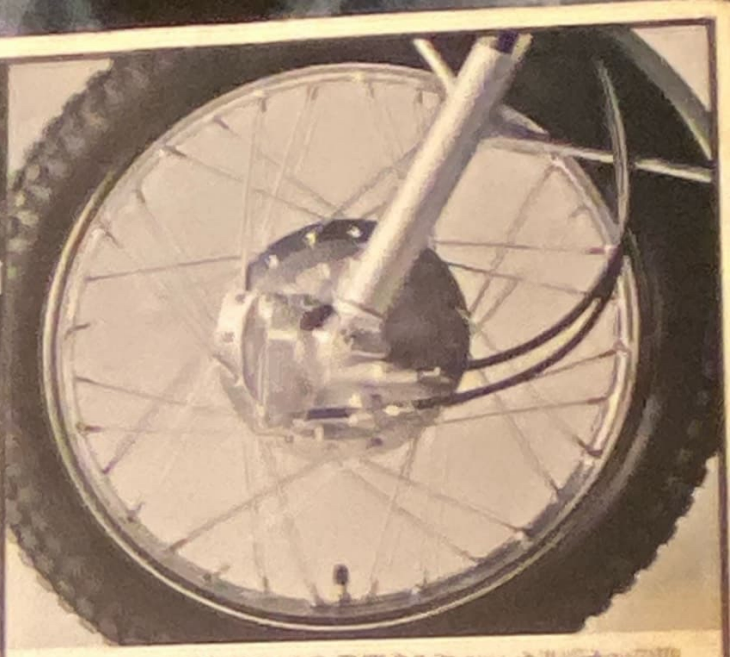
● 前輪は、前フォークによって支えられている。前フォークは、前輪を安定に保ち、操縦性を向上させる。前フォークは、前輪の回転を伝えます。
