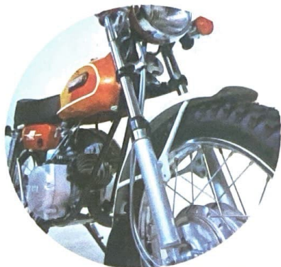
●路面のショックをやんわりと吸収するセリアーニタイプのフロントフォーク
