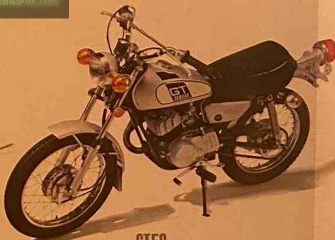
GT50 ● ¥98,000 ●2サイクル・空冷 ●4馬力 ●リターン式4段 ●シルバーダスト、コンペティションイエロー、ハイスピークライトグリーン
