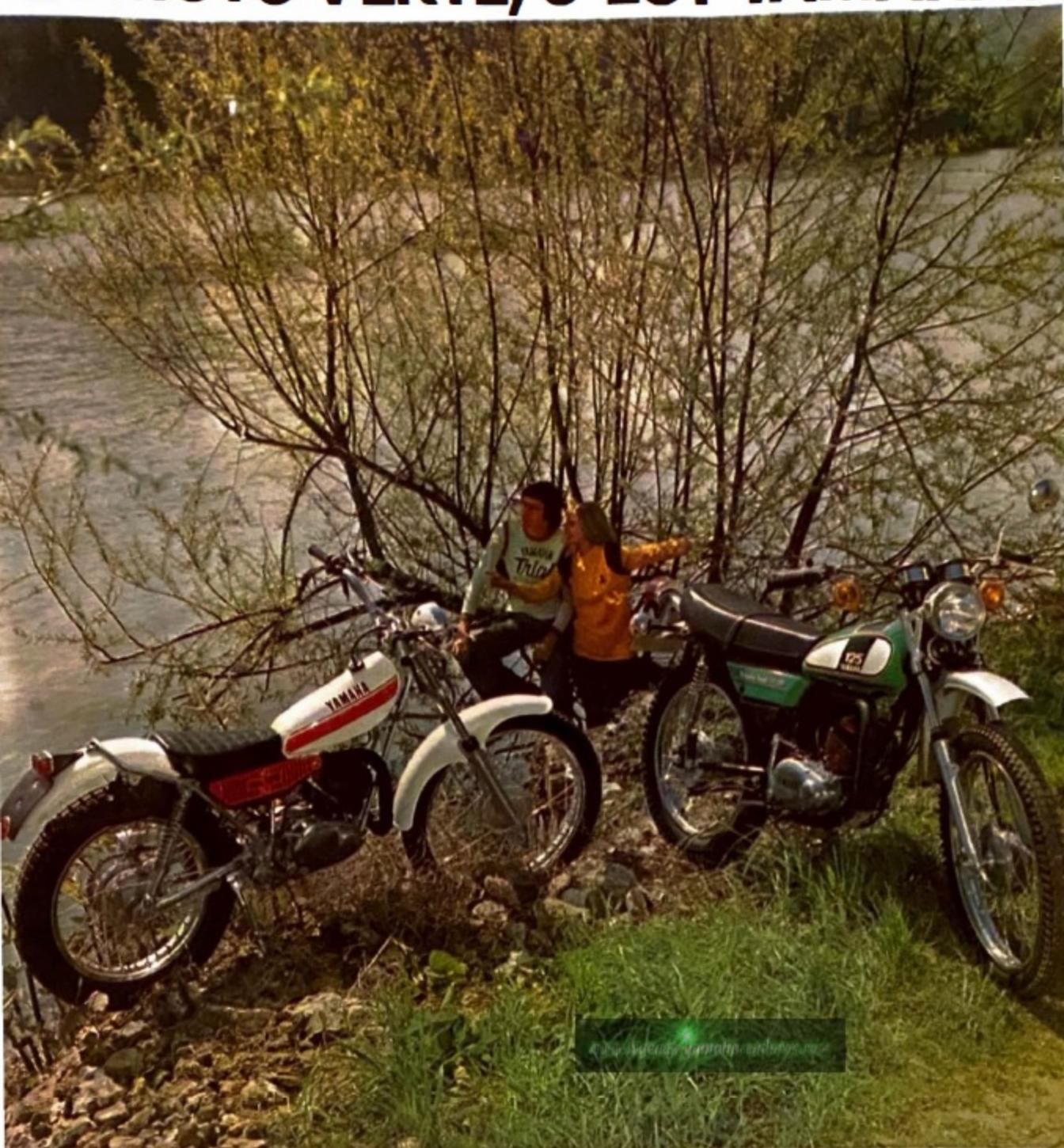
TY 125 - Monocylindre - 2 temps - 6 vitesses - 82 kg - 12,5 CV - 95 km/h - rouge et blanc - clefs en main **4.857 F TTC**
