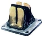
Le fonctionnement dû aux variations de pression à l'intérieur même du moteur entraîne l'ouverture et la fermeture des clapets, alimentant rationnellement le moteur et empêchant le reflux à travers le carburateur.
